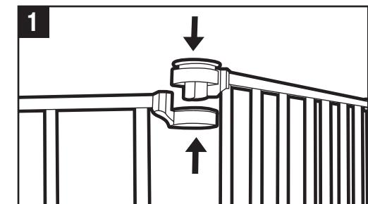
**2** Une fois toutes les sections assemblées, soulever tous les capuchons de verrouillage en position (a) déverrouillée (relevée) et ajuster l'angle de chaque section jusqu'à obtention de la configuration souhaitée (b). Rabaisser tous les capuchons de verrouillage (c).
