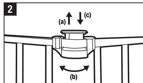
**3** Para quitar una sección, coloque el pulgar y el dedo índice debajo del poste de la bisagra superior y apriete a la vez que levanta.
