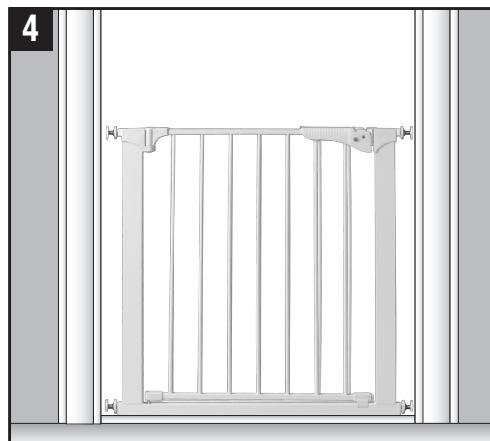
**4** Centrer la barrière dans l'ouverture, avec le rail inférieur en appui par terre. Les espaces de chaque côté doivent être de longueur identique. **IMPORTANT :** La barrière doit être installée de niveau et au carré sur la hauteur et sur la largeur, sinon sa porte à fermeture ne fonctionnera pas correctement.
